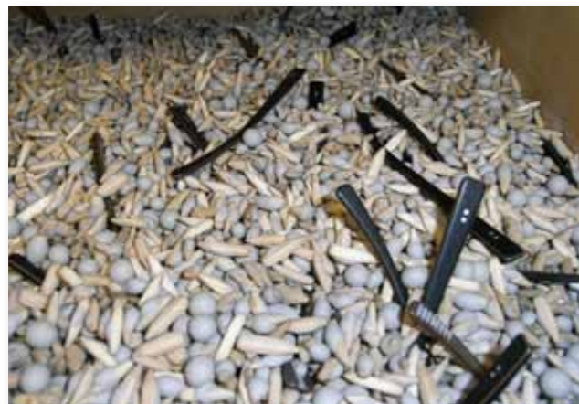
Der mehrtägige Polierprozess bei Acetatabügeln beginnt in der Trommelanlage
