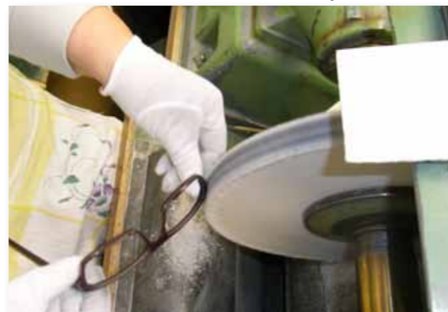
Erst durch aufwändiges Polieren von Hand bekommt das Acetat seinen besonderen Glanz
